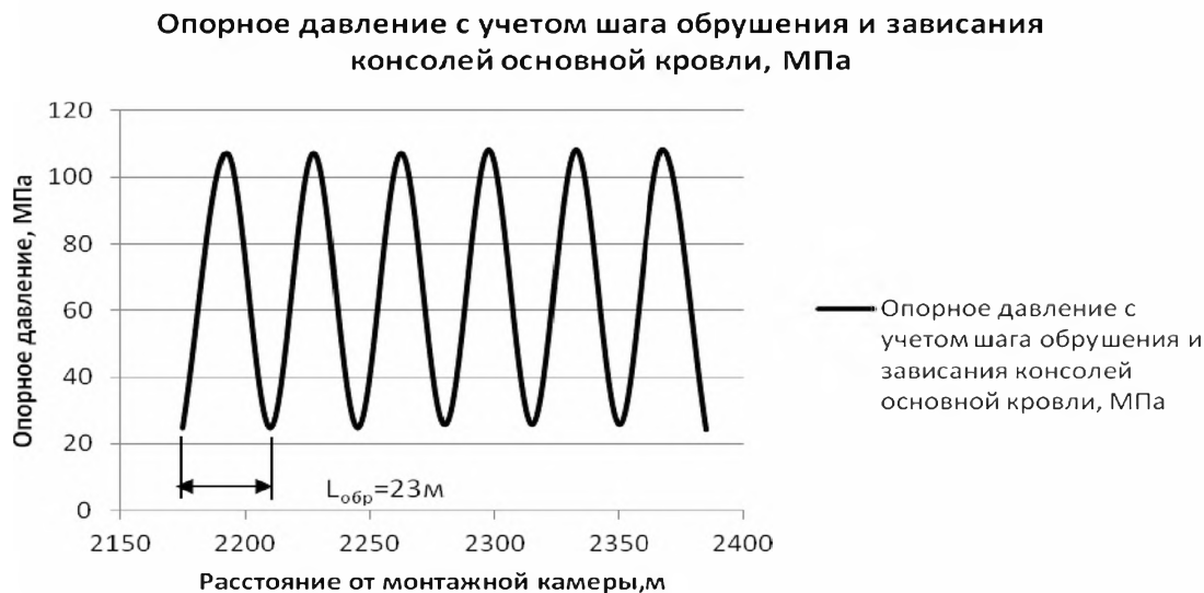
Рис. 7. Проявление интенсивности (скачков) опорного давления в момент обрушения пород активного слоя у границы отработки выемочного столба 18-27 (по манометрам – самописцам) Fig. 7. A manifestation of intensity (spikes) of the reference pressure at the moment of collapse of rocks in the active layer near the border of the mining pillar 18-27 (pressure – recorder)
