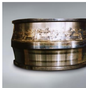
Рисунок 1. Дефект двухрядного подшипника качения: а) износ тел качения подшипника качения; б) износ беговой дорожки подшипника качения.
