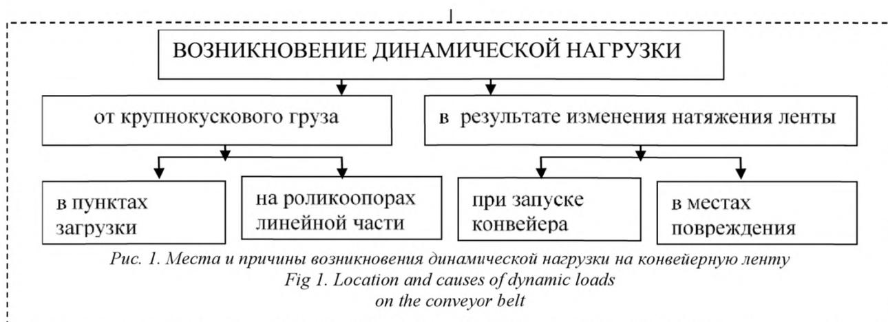
Рис. 1. Места и причины возникновения динамической нагрузки на конвейерную ленту
