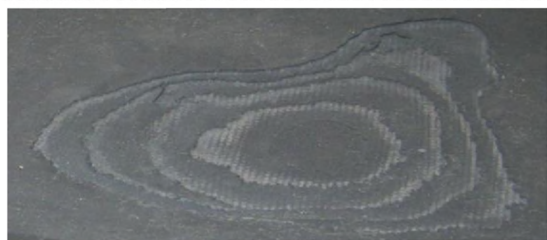
Рис. 4 Прожог конвейерной ленты единичным куском Fig. 4 Burn-through of the conveyor belt by a single lump
