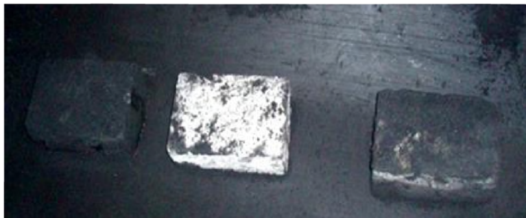
Рис. 3. Расчистка крупных кусков на ленте от зернистых фракций насыпного груза Fig. 3. Clearing large lumps on the belt from granular fractions of a bulk cargo
