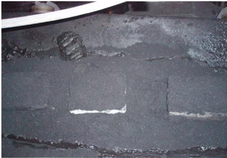
Рис. 2. Расположение крупных кусков в конце транспортирования в среде зернистых фракций Fig. 2. Arrangement of large lumps of coal at the end of transportation among granular fractions
