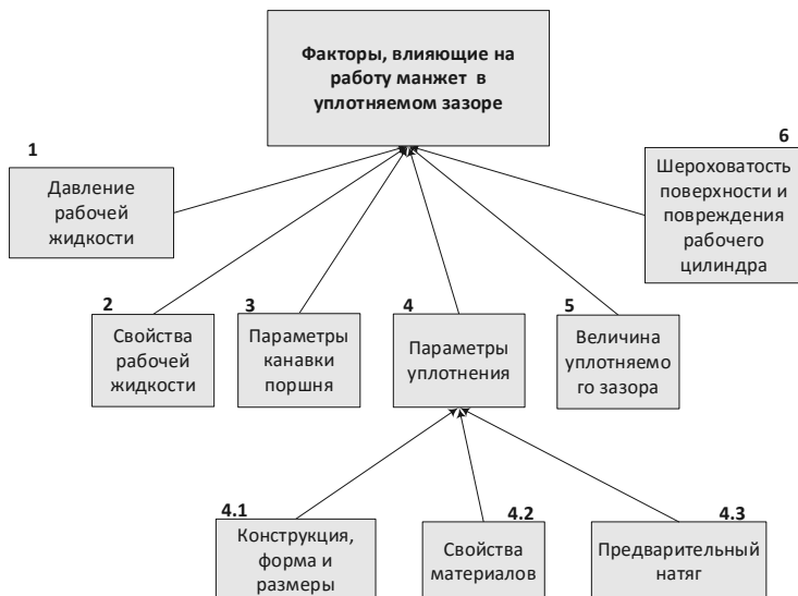
Рис. 7. Классификация факторов, оказывающих влияние на работу манжетных уплотнений гидростоек механизированных крепей
