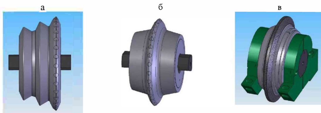
Рис. 1. Дисковые инструменты: а – многолезвийный; б – с прерывистой режущей кромкой армированной твердосплавными вставками; в – со сплошной режущей кромкой
