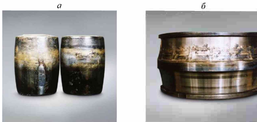
Рис. 10. Дефект двухрядного подшипника: а) износ тел качения подшипника качения; б) износ беговой дорожки подшипника качения
