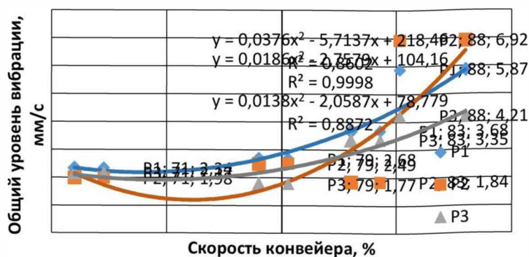
Рис. 12. График зависимости общего уровня вибрации в диапазоне 100-2000 Гц от скорости движения ленты конвейера
