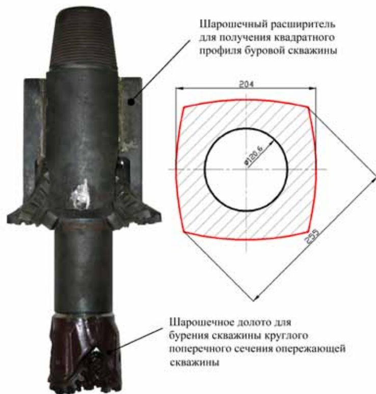
Рис. 1. Буровой инструмент для промышленных испытаний и форма скважины
