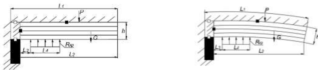
Рис. 1. – Расчетная схема при распределенной нагрузке крепи (перед хрупким разрушением)
