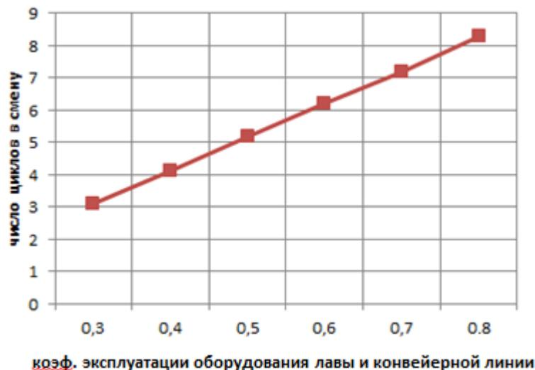
Рис. 3. Зависимость числа циклов в смену от коэффициента  $k_{экс}$  при времени цикла 65,2 мин, на примере лавы 52-13
