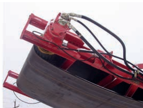
Рисунок 3. Привода скребкового конвейера (а) и ленточного перегружателя (б) комплекса Superior Highwaal Miners Figure 3. Scraper conveyor drive (a) and belt conveyor (b) of Superior Highwaal Miners
