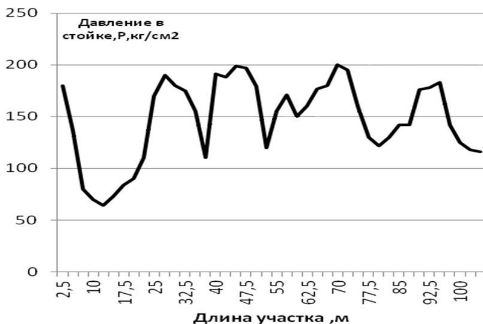
Рис. 1. График изменения давления в поршневой полости гидростойки секции крепи в очистном забое 18-27 в привязке к длине исследуемого участка
