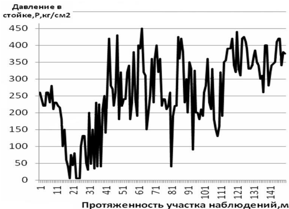
Рис. 2. График изменения давления в поршневой полости гидростойки секции крепи в очистном забое 18-29 в привязке к протяженности участка наблюдений
