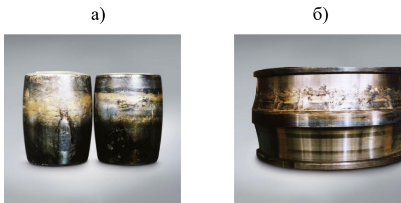
Рисунок 1. Дефект двухрядного подшипника: а) износ тел качения подшипника качения; б) износ беговой дорожки подшипника качения.
