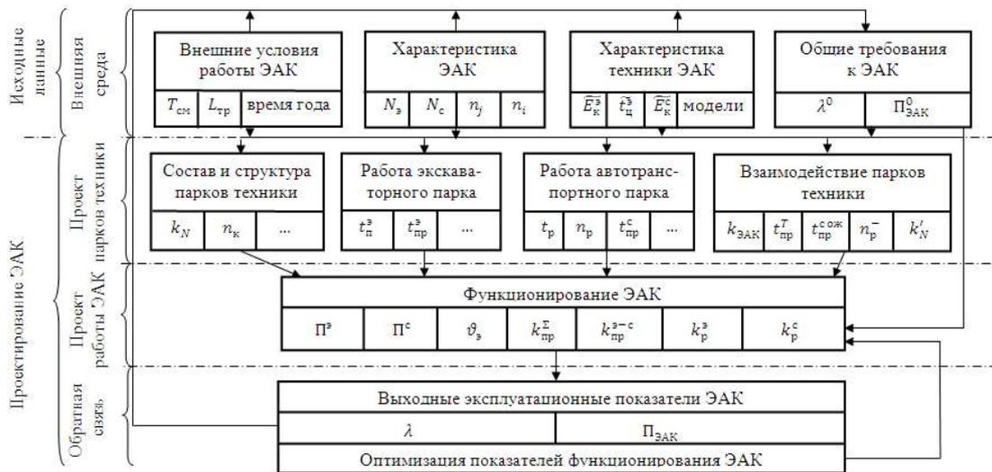
Рис. 1 Структурная схема проектирования карьерного ЭАК и оптимизации его функционирования
