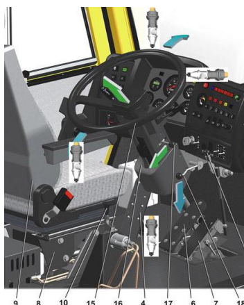
Рис. 1 – Схема измерения вибрации на сидении, полу кабины и рулевом колесе
