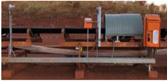
Рис. 4. Датчик BG10k от Beltscan; а) установка на конвейере, б) принцип работы Fig. 4. Probe BG10k, Beltscan; а) installation on conveyor, б) operating principle
