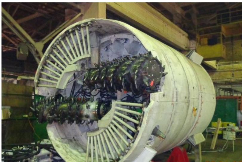
Рисунок 1. Опытный образец ПА модели «401» диаметром 3,2 м
