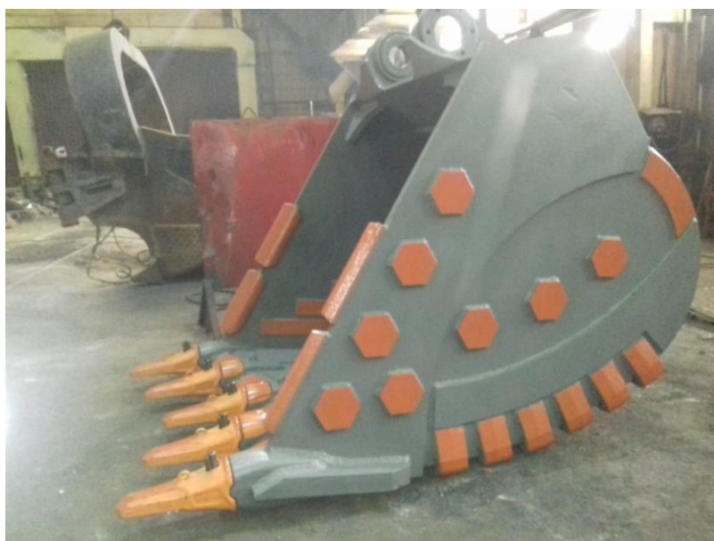
Рисунок 1. Ковш энергоэффективного конструктивного исполнения для экскаватора KOMATSU PC-1250
