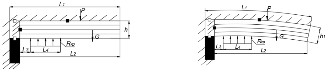
Рис. 1. – Расчётная схема конечно-элементной модели на первом этапе исследований
