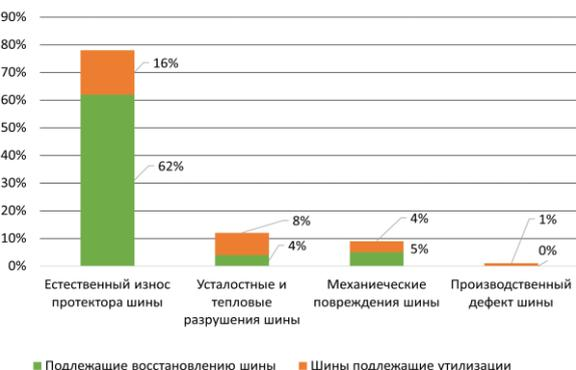
Рис. 2. Распределение отказов крупногабаритных шин по видам дефектов
