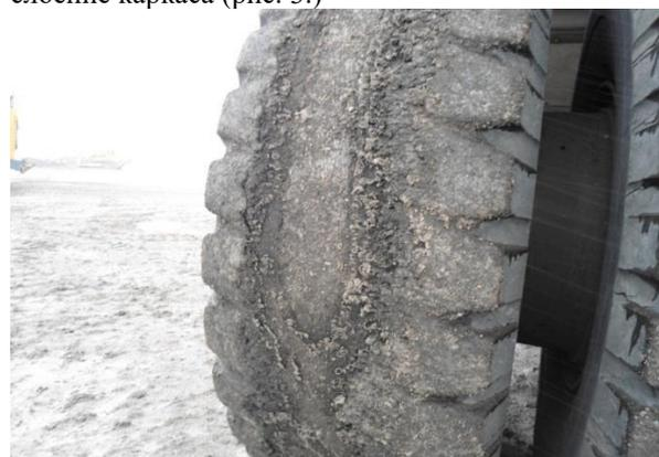
Рис. 3. Отслоение протектора
