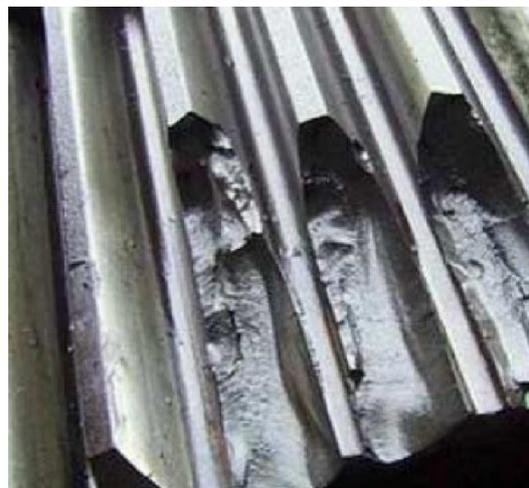
Рис. 3. Выявленный дефект зубчатой полумуфты
