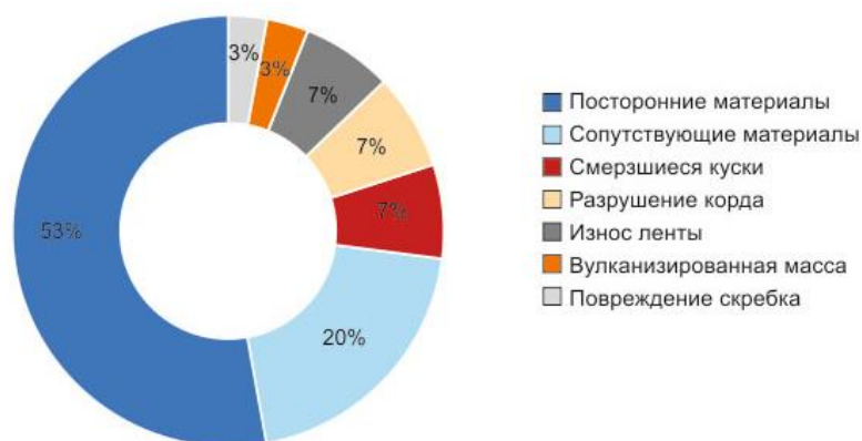
Рис.1. Причины разрыва ленты конвейера
