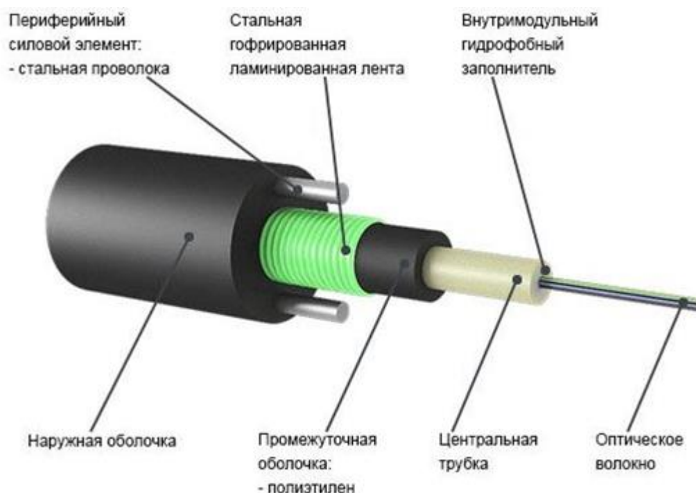
Рис. 4. Конструкция оптоволоконного кабеля
