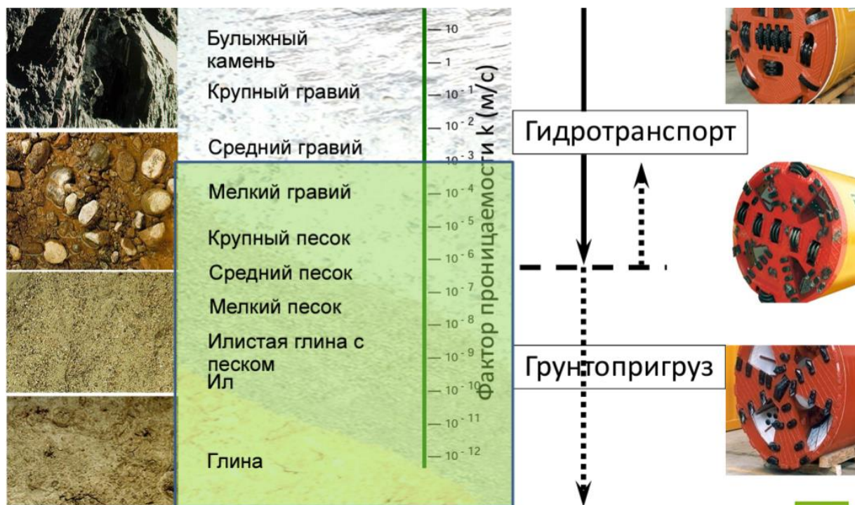
Рис. 20. Схема выбора рационального ИО в зависимости от условий проходки [13] Fig. 20. Scheme for selecting a rational executive body depending on tunneling conditions [13]
