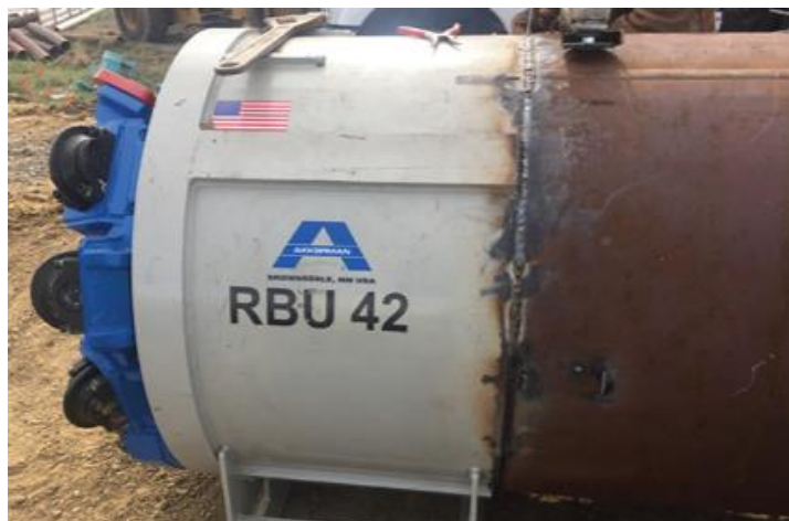
Рис. 9. ИО RBU [6] на подставке (а) и приваренный к обсадной трубе (б) Fig. 9. Executive body of RBU [6] on the stand (a) and welded to the casing pipe (b)
