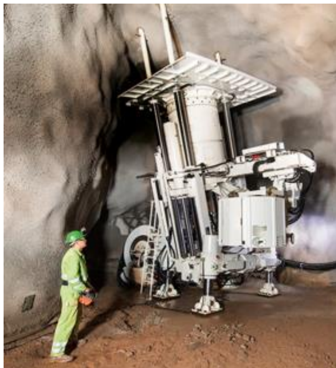
Рис. 24. Установка для бурения восстающих выработок Fig. 24. Raise boring machine
