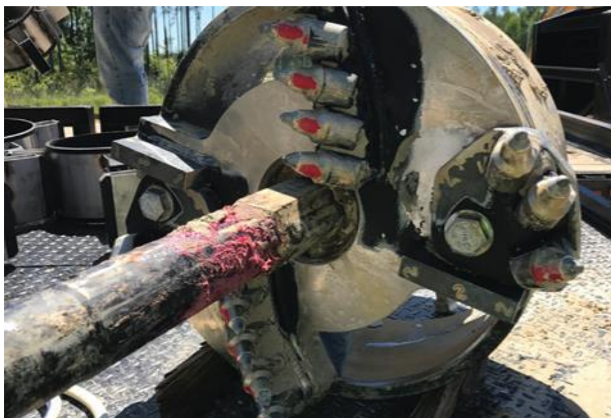
Рис. 7. Буровая установка GBM (а), расширители GRS-50 (б) с наружным диаметром 610 мм, 762 мм, 914 мм и 1067 мм, расширитель после эксплуатации (в) [5, 6]
