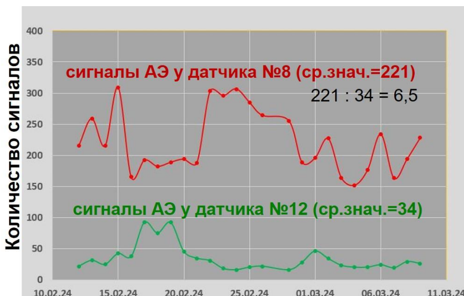
Рис. 15. Активность АЭ сигналов за месяц (датчики № 8 и 12)
