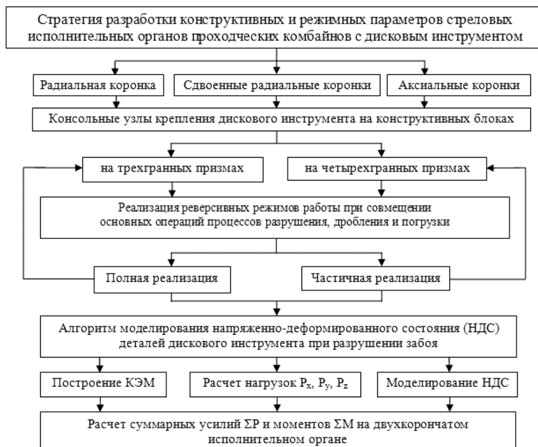
Рисунок 1 — Конструктивные и режимные параметры исполнительных органов проходческих комбайнов с дисковым инструментом
