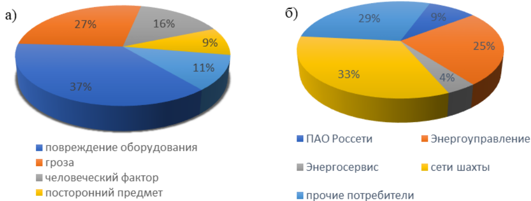
Рис.4. Причины и место аварий систем внешнего электроснабжения шахт Fig.4. Causes and location of mine external power supply system failures
