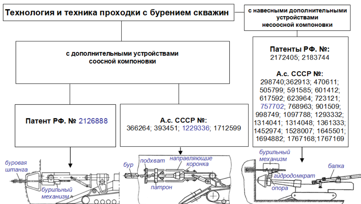
Рисунок 1 – Компоновка дополнительных устройств на проходческих комбайнах для буровых процессов
