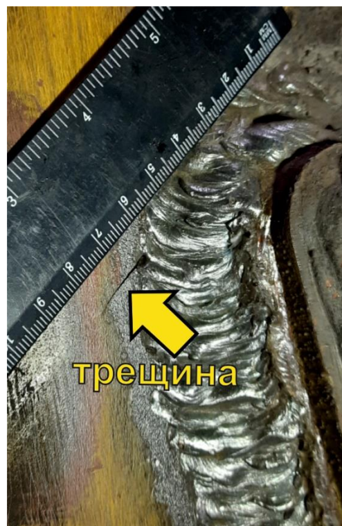
Рис. 13. Трещина в сварном шве, образовавшаяся после проведенного ремонта Fig. 13. Crack in the weld after repair
