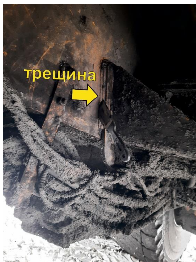
Рис. 8. Трещина в сварном шве рамы
