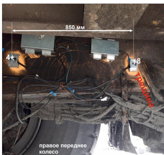
Рис. 10. Схема установки датчиков АЭ Fig. 10. Scheme of AE sensors installation
