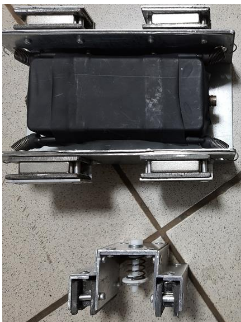
Рис. 6. Магнитные держатели для предусилителей и датчиков
