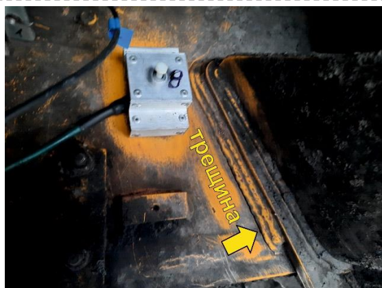
Рис. 9. Датчик АЭ, установленный на магнитном держателе Fig. 9. AE sensor mounted on a magnetic holder
