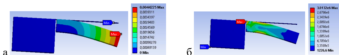
Рис. 2. а) деформированное состояние в момент после хрупкого разрушения, б) напряженное состояние в момент после хрупкого разрушения
