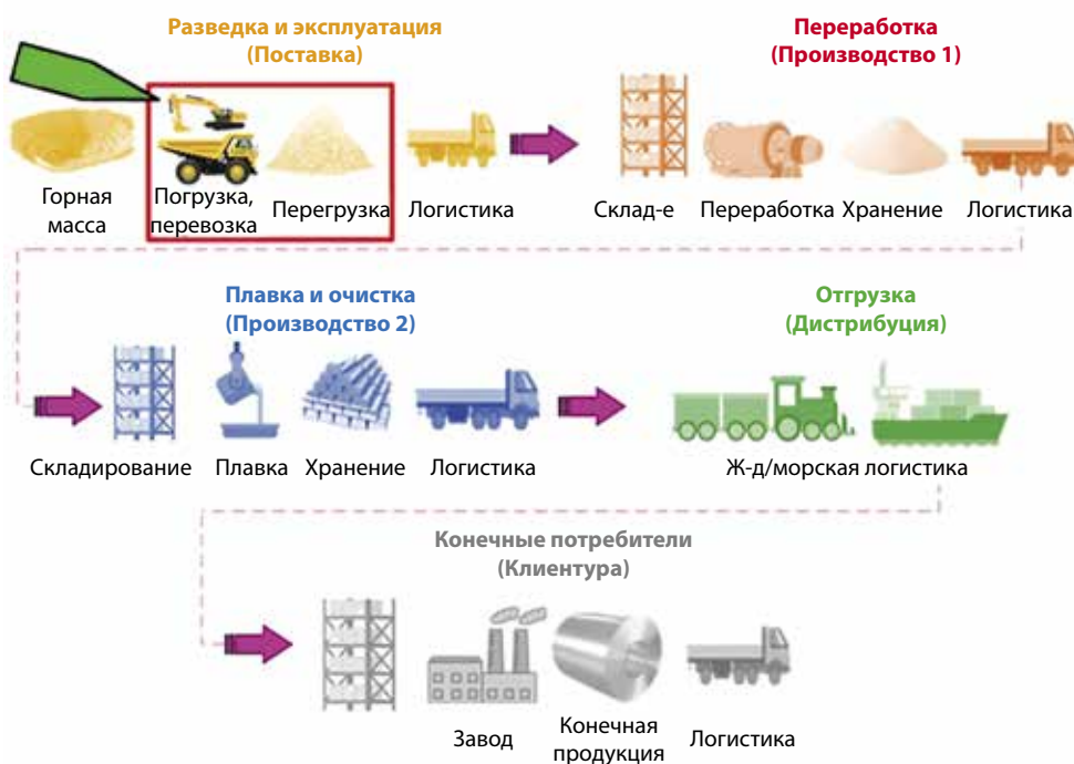
Рис. 1. Комплексная цепочка поставок горнодобывающей промышленности, интегрированная с системой управления парком техники [14] Fig. 1. Integrated mining supply chain with fleet management system [14]
